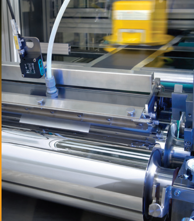
Kopf des Rolle zu Rolle Beschichters
