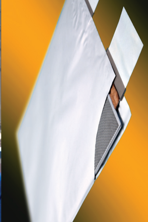
Kontaktier- und Durchführungsbereich einer Pouchzelle
